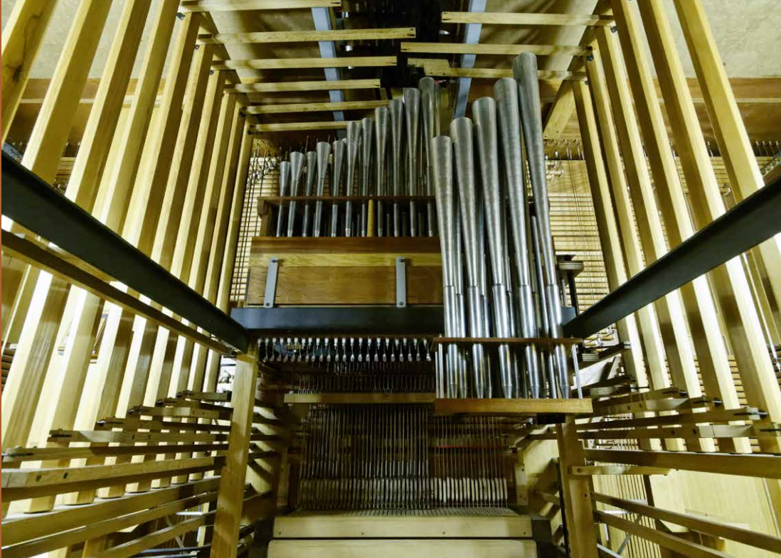
De registermechaniek en de pijpen van het Echo in de onderkas achter de klavieren.
